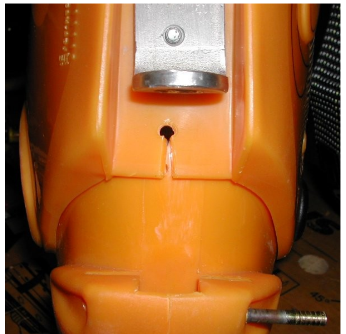
Illustration 9.: En position flexion maxi. Le débattement est limité par la compression des ressorts.
